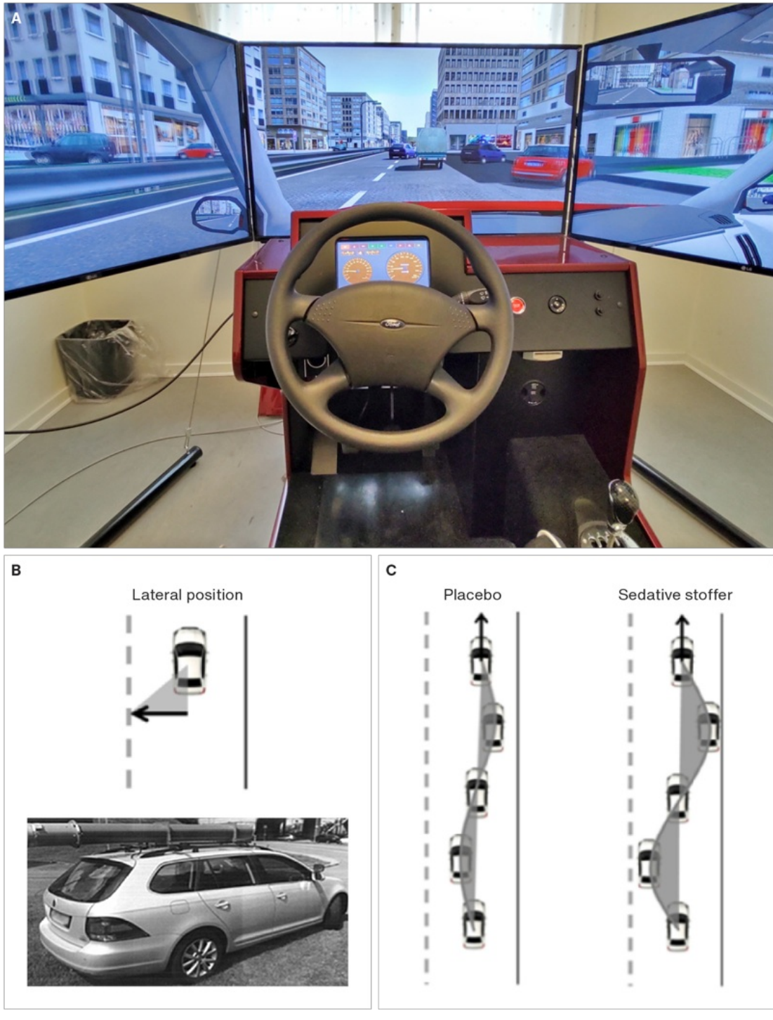
FIGUR 1 A. En køresimulator med rat, pedaler og skærme, der afbilder diverse scenarier, som styres via en tilsluttet computer. B. En bil anvendt til standardiserede kørestests på motorvej udstyret med diverse udstyr til måling af position. C. En skematisk tegning af den laterale afstand til vejstriben.
