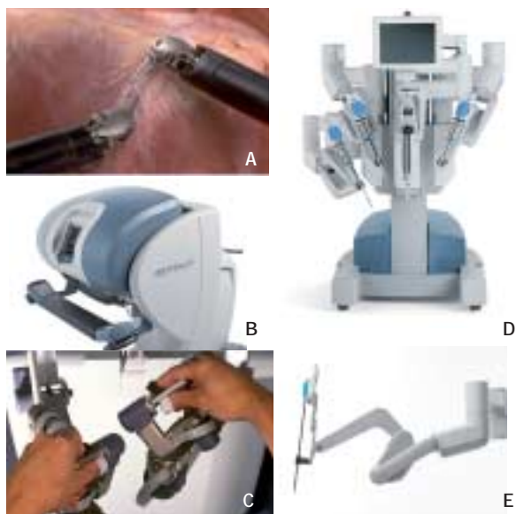
Figur 1. Operatøren ser billedet (A) ved at kigge i okularporten i konsollen (B). Robotarmene styres ved hjælp af to håndtag (C). Robotenheden (D) med en robotarm i detalje med påmonteret instrument (E).
