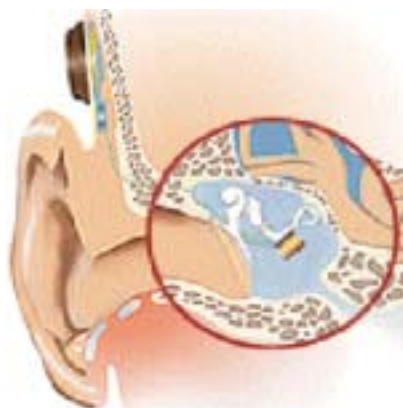
Figur 1. Semiimplanterbart høreapparat: Vibrant Soundbridge. Lyden omdannes til elektriske impulser og overføres via en magnetspole til en transducer, der er klipset på ambolten.
