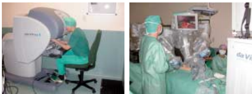
Figur 1. Telerobotics forventes at få stor betydning for den fortsatte udvikling af avanceret minimalt invasiv leverkirurgi. Her ses »da Vinci« i arbejde. Robotten består af en manøvreredel (til venstre), og en instrumentstøtte (til højre). Foto: A. Montgomery.
