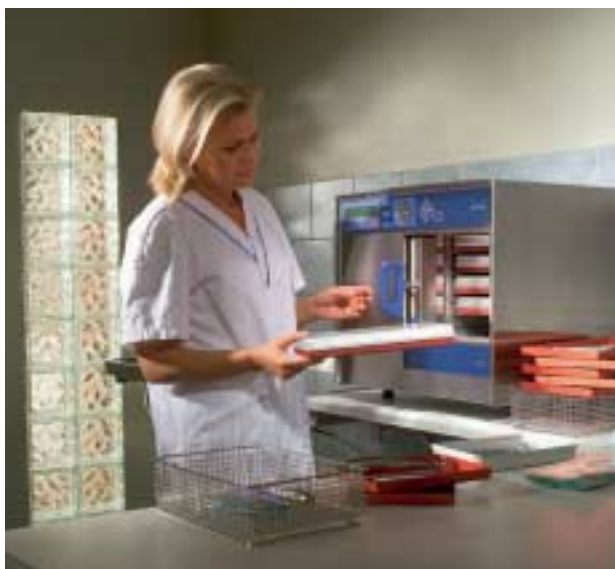
Figur 1. Opvaskedekontaminator, som udfører mekanisk rengøring og termisk desinfektion i en og samme proces. Her er vist en lille bordmodel.
