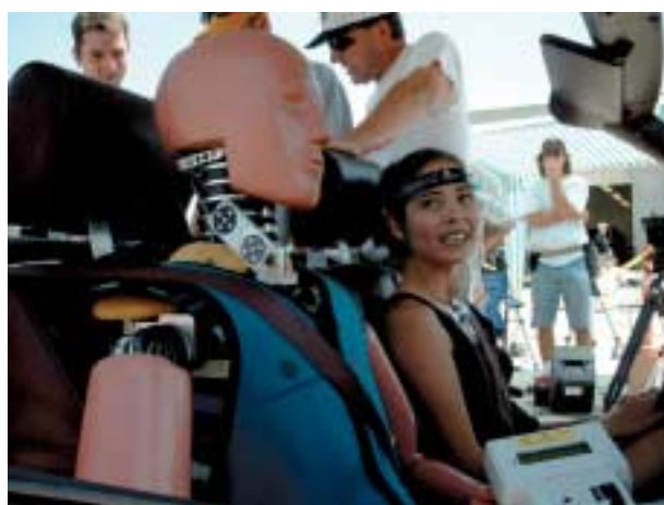
Figur 1. Forberedelse af passagerer forud for kontrolleret påkørsel bagfra ved lav hastighed.
