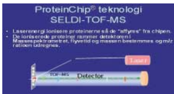
Figur 1. Illustration af vacuumrøret i massespektrometret. Proteinchippet beskydes med laser, så proteinerne ioniseres og affyres fra chippen. Detektoren rammes tidsmæssigt i relation til proteinernes masse, hvilket registreres som proteinprofiler. Gengivet med tilladelse fra CIPHERGEN Biosystems Inc.
