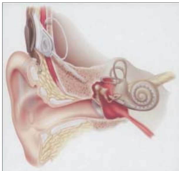
Figur 1. Apparatet ved kokleær implantation af døvfødte eller døvblevne patienter består af en ekstern enhed båret bag ved øret med mikrofon, processor og transmitter samt en intern, implanteret enhed bestående af en modtagerstimulator med tilhørende elektrode beliggende i cochlea.
