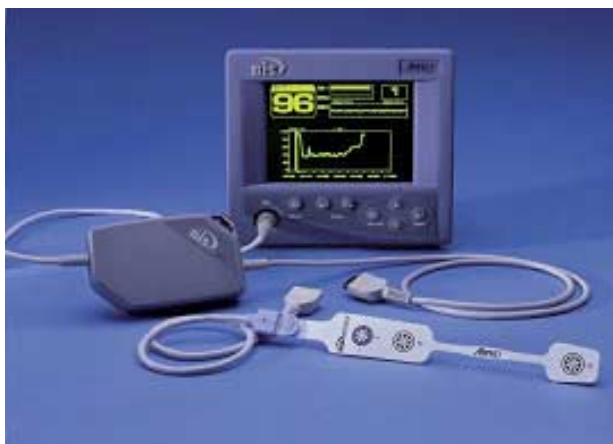
Figur 1. Bispektral indeksmonitor efter anæstesi. I forgrunden ses elektroderne, som klistres fast på patientens pande under anæstesen.
