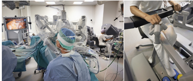
Operationsstue på Odense Universitetshospitals Robotkirurgisk Center. A. Til højre i billede ses konsolkirurgen, der har tre instrumenter tilgængeligt intraabdominalt; to ad gangen kan anvendes aktivt, mens det tredje instrument kan holde i strukturer. B. Fodpedaler og såkaldte håndcontrollere, som konsolkirurgen styrer kamera og instrumenter med. Patienten er vipet 30 grader Trendelenburg, og robotens tre arme er docket til trokare i bugvæggen.
